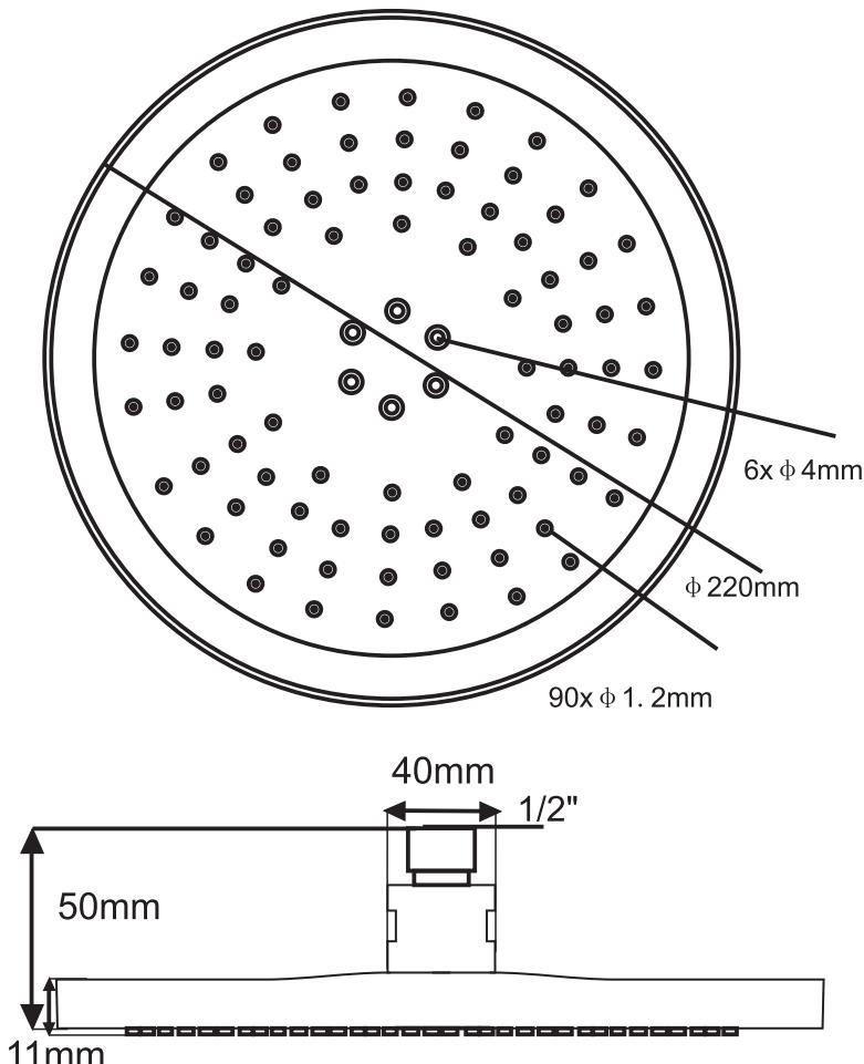
CZ - Průtok: 8,7 l/min při 5bar
