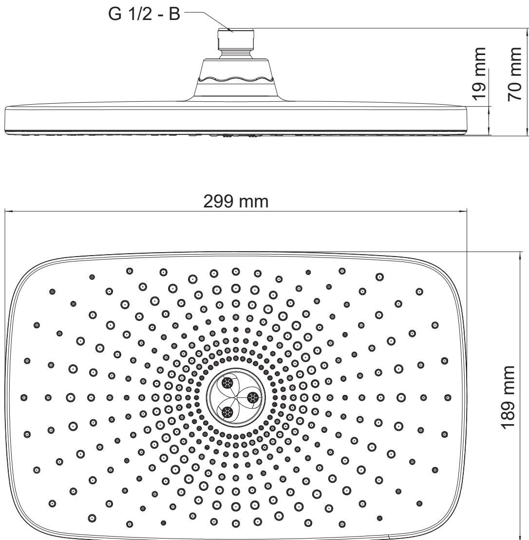
CZ - Průtok: 16 l/min při 5bar
