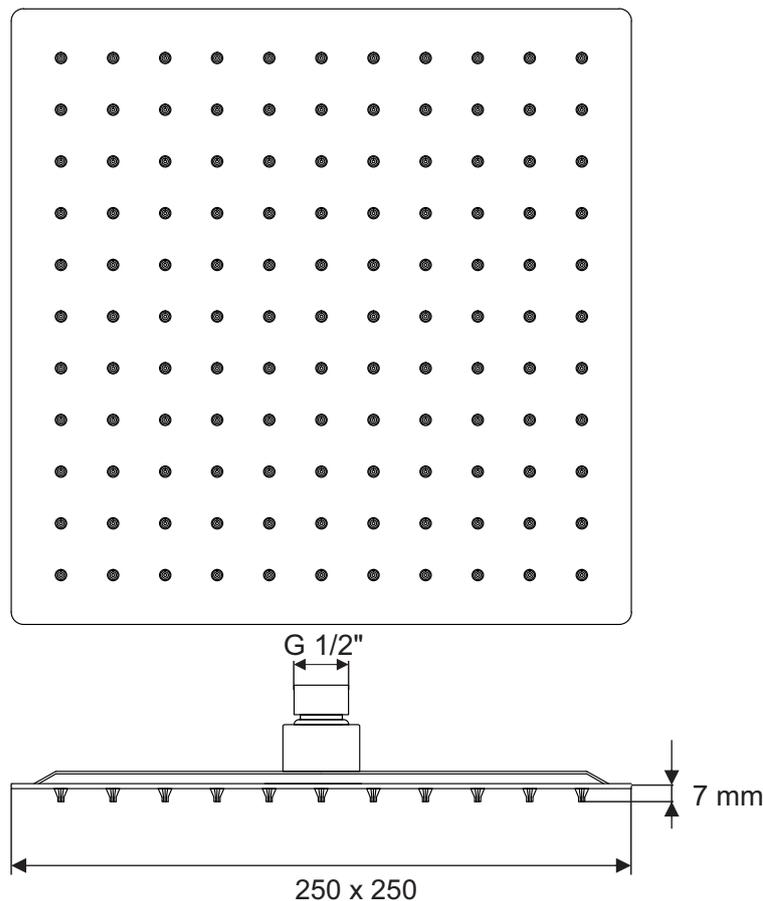
CZ - Průtok: 31,2 l/min při 5bar
